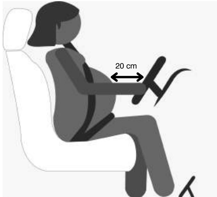
Ilustración demostrativa de separación entre la persona embarazada y el volante del vehículo.
