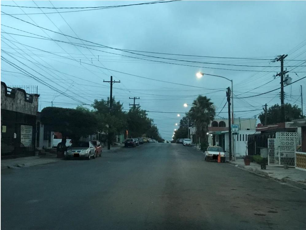
**Imagen C. Calle Cóndor ingresando por Calle Pelicano. Arroyo vial muy amplio con banquetas que no cumplen con normal estatal. Parada de autobús señalizada únicamente con un letrero azul.**
