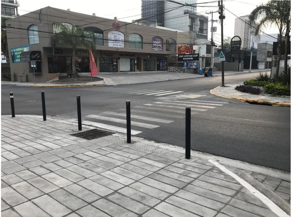
**Imagen C. Súper Parque Mississippi (cruce Río Mississippi con Río Moctezuma). Bolardos en cruce, cebra peatonal, rampa y pavimento podo-táctil. Alcantarilla y drenaje pluvial. Letrero verde de prioridad a ciclistas en arroyo vehicular.**
