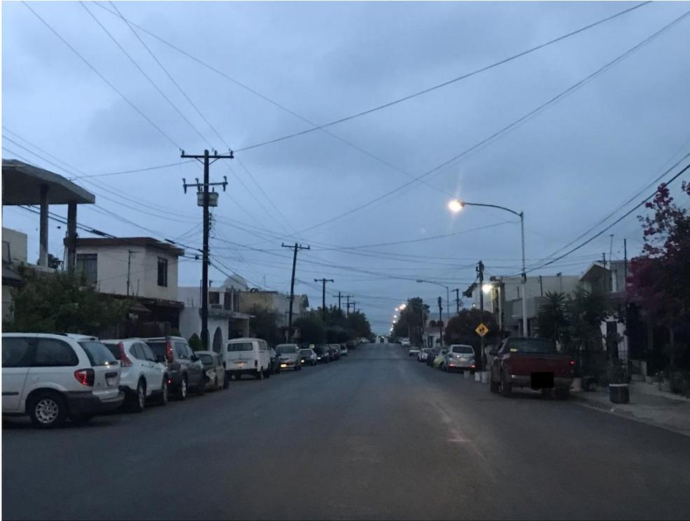
**Imagen B. Calle Cóndor ingresando por Calle Pelicano.** Arroyo vial muy amplio con banquetas que no cumplen con normal estatal, no hay cebras peatonales ni letreros que indiquen la velocidad de la zona. Hay un letrero de cruce peatonal. Reductor de velocidad o "bordo" no es visible.
