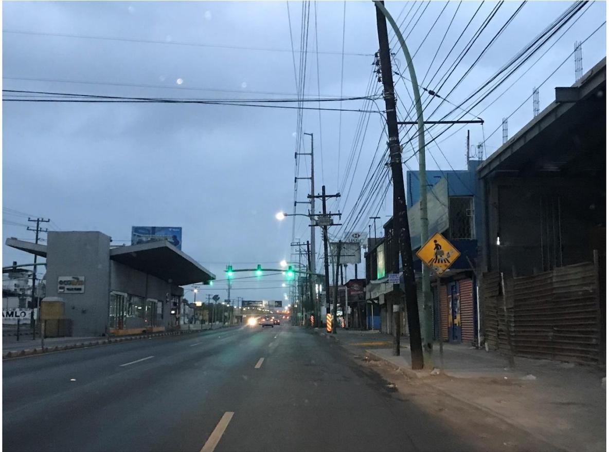
*Imagen F. Avenida Abraham Lincoln entre Agami y Pelicano. Amplio arroyo vehicular, no hay ciclovía (ciclistas usan Ecovía). Banqueta con muy reducido tamaño, con muchos obstáculos, sin rampas, sin pavimento podo-táctil.*
